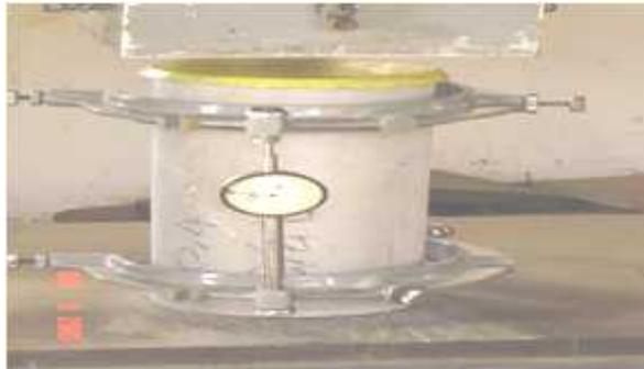
Gambar 1. Alat uji Tes Modulus Elastisitas Beton
