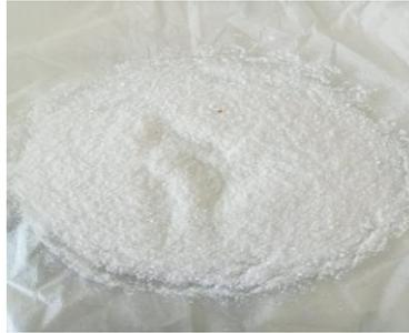
**Gambar 5** Hasil Silika Gel Termodifikasi  $\text{TiO}_2$
