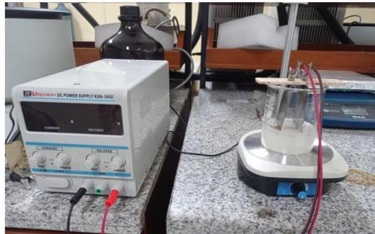
**Gambar 4.** Rangkaian alat Elektrokoagulasi
