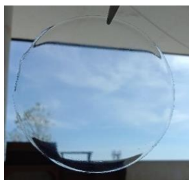
Gambar 1. PIM komposisi 50% PVC, 40% D2EHPA, dan 10% asam oleat
