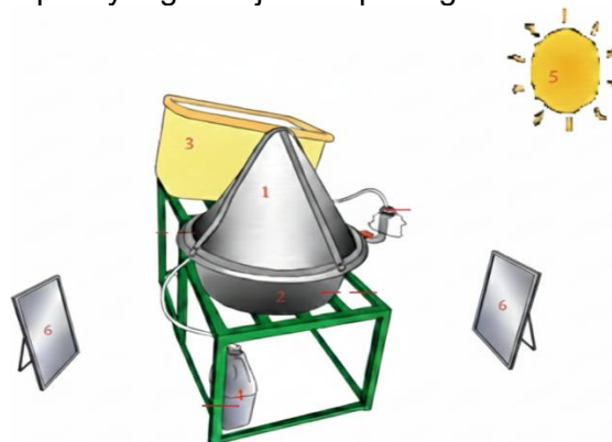
Gambar 5. Sketsa Alat Kondensasi
