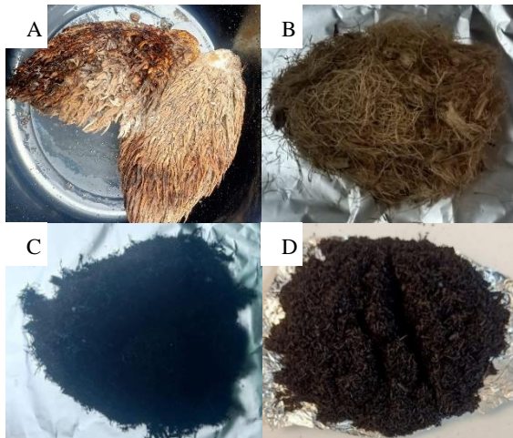
Gambar 1 . Proses pengerjaan adsorben (A) TKKS, (B) Hasil Preparasi, (C) Hasil Karbonisasi, (D) Karbon aktif TKKS
