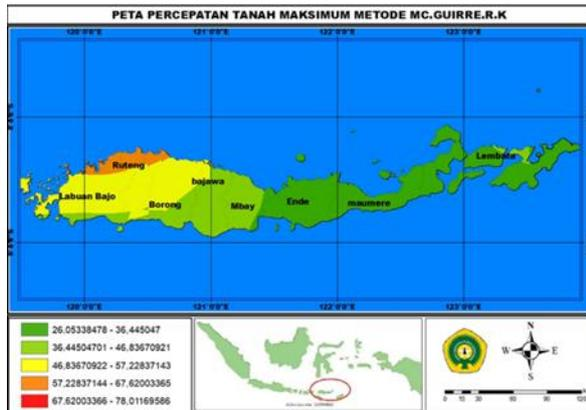
Gambar 2. Peta percepatan tanah maksimum dengan metode Mc.Guirre.R.K
