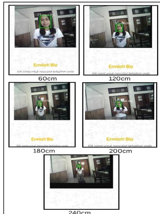
Gambar 10. Hasil Pengujian Varisi Jarak
