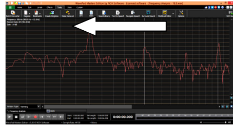
Gambar 8. Peletakan kursor untuk penentuan nilai frekuensi dan intensitas bunyi dawai
