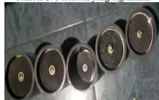
Gambar 4. Check Valve yang digunakan
