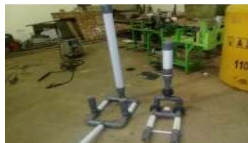
Gambar 2. Pompa hidram yang digunakan
