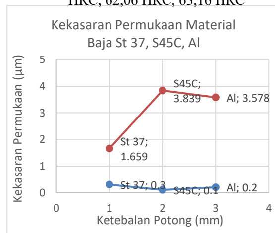
Grafik 3. kekasaran permukaan baja St 37, S45C, Aluminium dengan kekerasan masing masing pahat hardfacing
