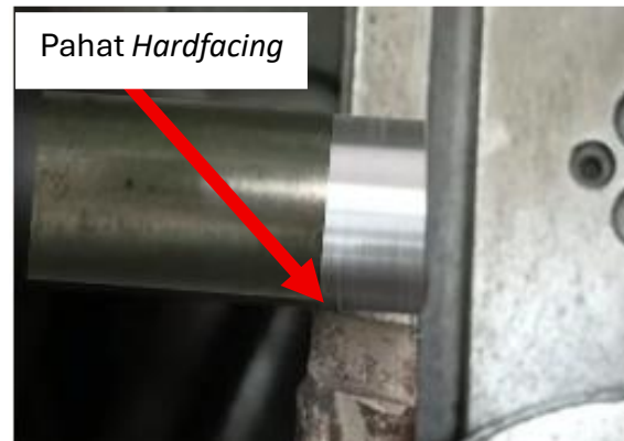
Gambar 10. Pembubutan material S45C dengan pahat hardfacing
