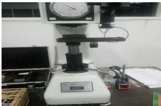
Gambar 2. Mesin uji kekerasan Darson Model MOPAO3
