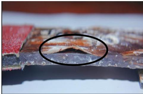
Gambar 4. *Debonding* pada spesimen yang di redam pada air laut
