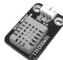
Gambar 2. Bentuk Fisik Sensor DHT11
