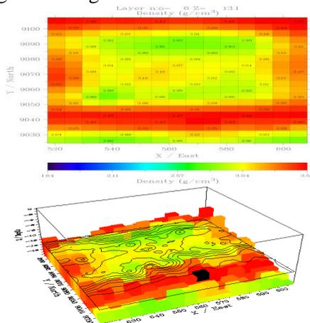
Gambar 15. Model 2D dan 3D lapisan keenam
