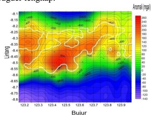
Gambar 1. Peta kontur anomali udara bebas (*free-air anomaly*)
