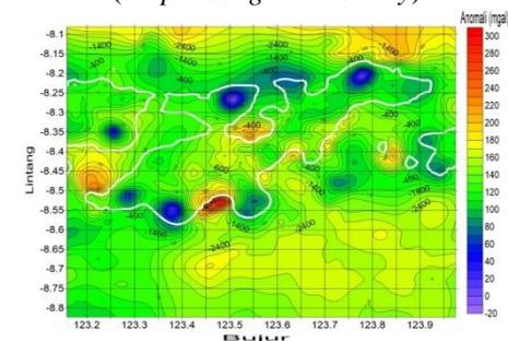
Gambar 4. Peta kontur anomali curvatur (*curvature anomaly*)
