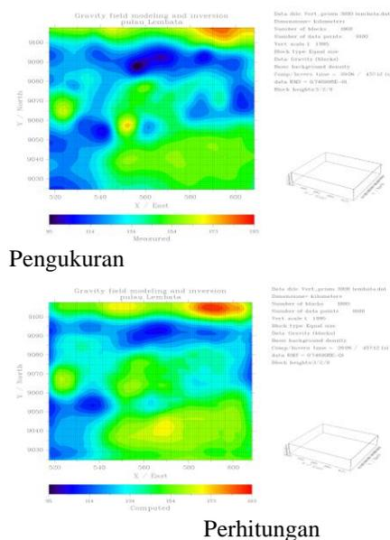
Gambar 9. Kontur perhitungan dan pengukuran hasil inversi
