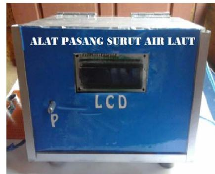
Gambar 3. Hasil perangkat alat ukur pasang surut
