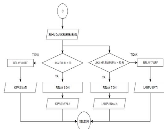
Gambar 13. Flow chart untuk pengontrol suhu dan kelembaban
