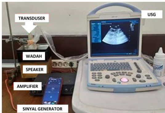
Gambar 3. Susunan ujicoba tahap pertama digunakan speaker sebagai sumber akustik eksternal. Dalam ujicoba ini digunakan sebuah plat besi sebagai obyeknya
