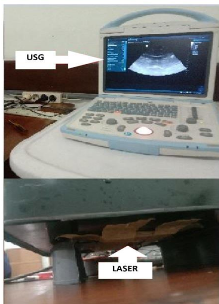
Gambar 6. Susunan penggunaan laser sebagai sumber akustik eksternal dengan memanfaatkan efek fotoakustik.
