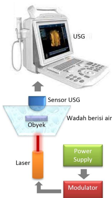
Gambar 1. Skema percobaan pembentukan citra USG dengan sumber akustik eksternal berupa laser yang dimodulasi
