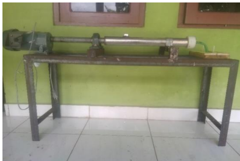
Gambar 3. Prototype mesin pencetak spesimen yang telah selesai dibuat
