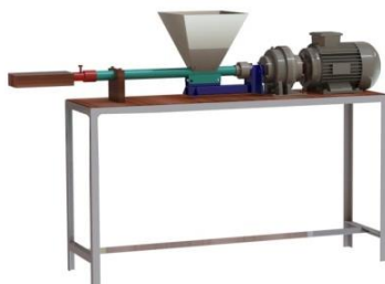
Gambar 2. Rancangan mesin pencetak spesimen dengan sistem injeksi
