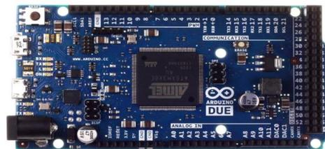
Gambar 1. Arduino Due
