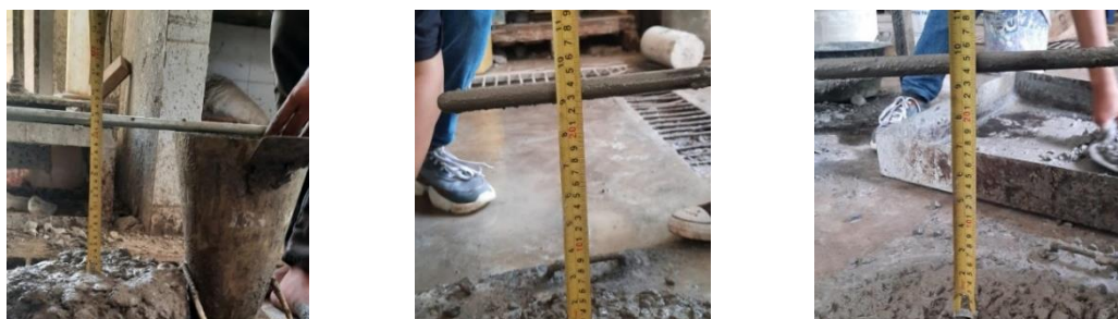
Gambar 2. . Hasil Pengujian Slump Final Campuran 55, 60, dan 65 MPa
