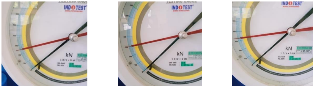
Gambar 3. Hasil Pengujian Kuat Tekan Trial Mix Campuran 55, 60, dan 65 MPa
