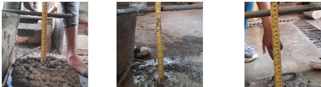
Gambar 1. Hasil Pengujian Slump Trril Mix Campuran 55, 60, dan 65 MPa
