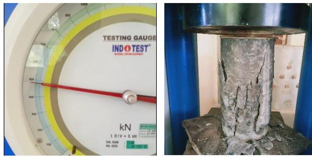
**Gambar 3.** Sampel Hasil Pengujian Kuat Tekan Beton Menggunakan Komposisi JMF
