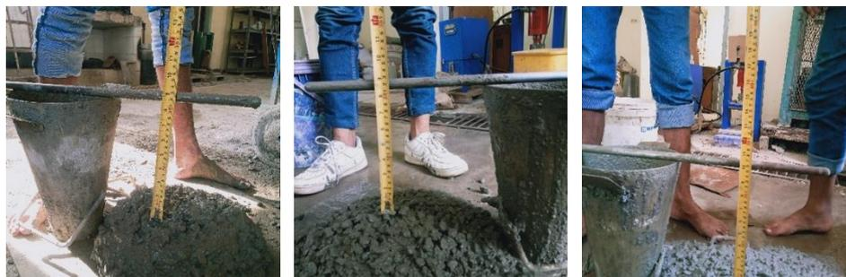
**Gambar 2.** Sampel Hasil Pengujian *Slump Test* Menggunakan Komposisi JMF
