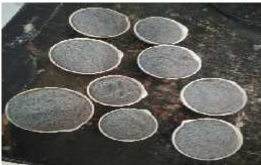
Gambar 5. Hasil Pembakaran Bamboo Leaf Ash Menggunakan Tanur
