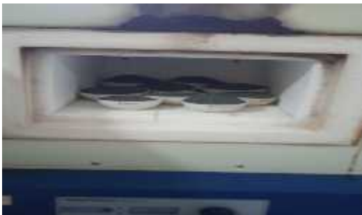
Gambar 4. Pembakaran Bamboo Leaf Ash Menggunakan Tanur
