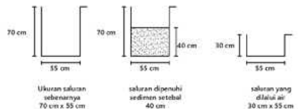
Gambar 1. Kondisi Saluran yang dilalui
