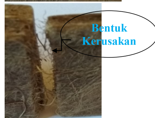
Gambar 6. Bentuk Kerusakan Spesimen Akibat Pembebanan Tarik
