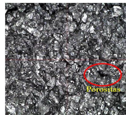
Gambar 8. Hasil uji mikroskopik 90% matrik
