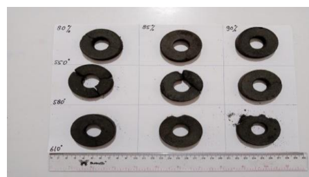
Gambar 3. Hasil hasil uji penekanan dua arah
