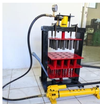
Gambar 14. alat pencetak briket dengan sistem hidrolik
