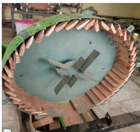
Gambar 5. Hasil pemasangan sudut bentur
