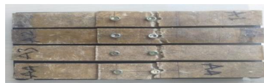
Gambar 5 Foto Makro Kerusakan Spesimen Jarak Lubang 36 mm
