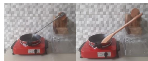
Gambar 3. Pengujian ketahanan aus lapisan teflon Maxim
