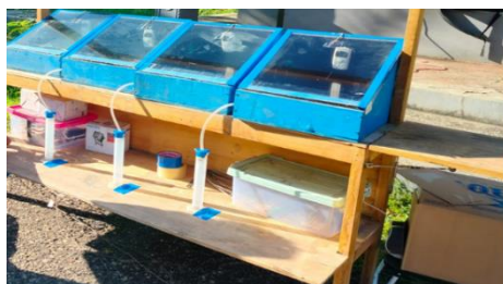
Gambar 3. Situasi pengujian 4 basin desalinasi
