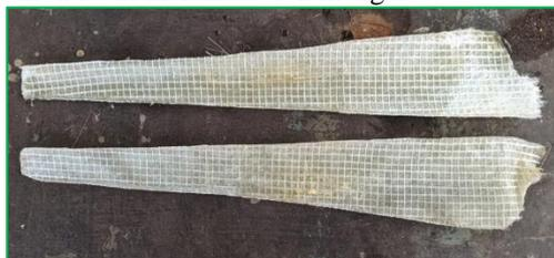
Gambar 17. Hasil cetakan blade test pertama
