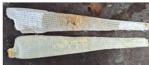
Gambar 18. Hasil cetakan blade test kedua
