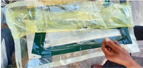
Gambar 12. Pembuatan *vacuum bag*
