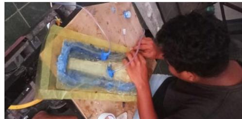
Gambar 15. Pemasangan *vacuum bag*
