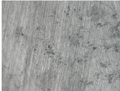
Gambar 2. Struktur Mikro Spesimen tanpa Perlakuan dengan Pembesaran 10x
