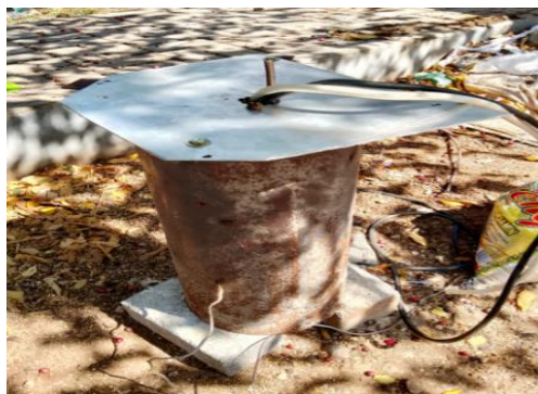
Gambar 3. Alat penelitian sebagai wadah penyimpanan energi thermal
