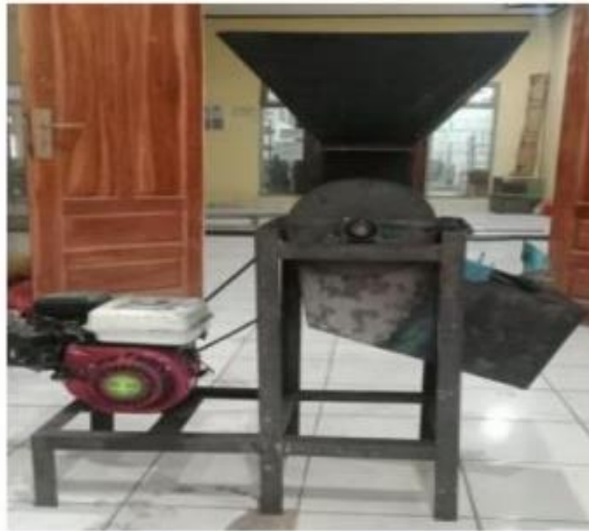
Gambar 2. Hasil Perancangan Alat Penghancur Arang Biomassa
