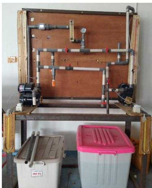
Gambar 2. Instalasi pengujian pompa tunggal dan dihubungkan paralel.
