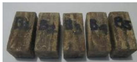
Gambar 3. Spesimen Uji Kuat Tekan ASTM D695-02a
