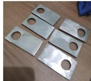
Gambar 3. Hasil Deburring spesimen uji Baja carbon rendah (Sumber: Dokumentasi Pribadi)
