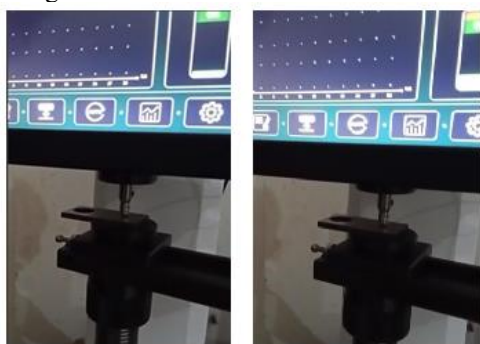
Gambar 4. Uji kekerasan baja carbon rendah menggunakan metode RockWell (Sumber: Dokumentasi Pribadi)
