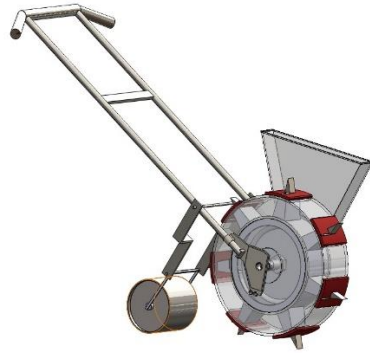
Gambar 1. Sketsa desain ulang alat penanam jagung
