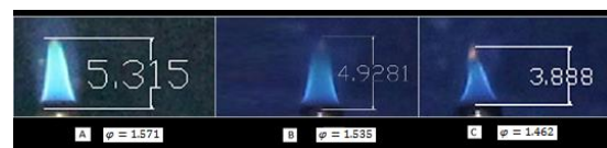
Gambar 6. Visualisasi nyala Api pada pada debit udara 30 ml/min.
