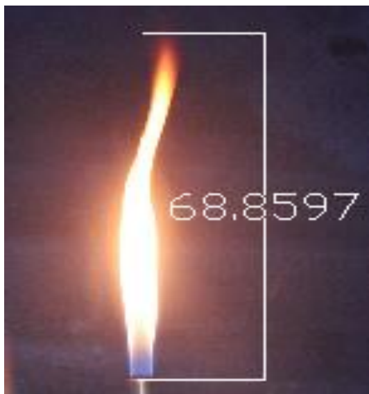
Gambar 5. Tinggi nyala api dari pembakaran difusi dengan campuran bahan bakar solar murni 70% dan minyak kelapa 30%.
