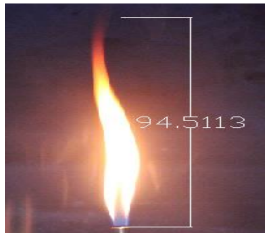
Gambar 3. Tinggi nyala api dari pembakaran difusi dengan campuran bahan bakar solar murni 90% dan minyak kelapa 10%.
