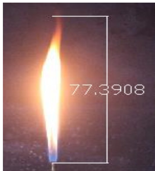
Gambar 4. Tinggi nyala api dari pembakaran difusi dengan campuran bahan bakar solar murni 80% dan minyak kelapa 20%.
