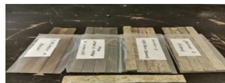
Gambar 2. Spesimen Uji Tarik Setelah di cetak
