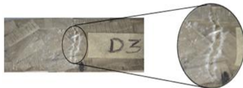
Foto Makro Patahan Spesimen hybrid ( serat glass + chip daun gewang
