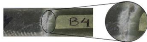
Foto Makro Patahan Spesimen Serat Gelas
