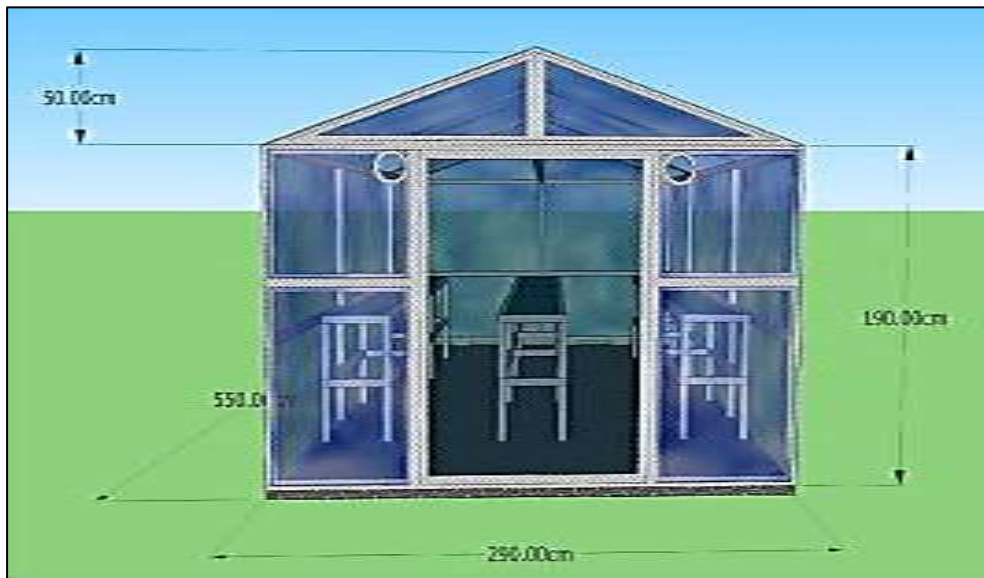
Gambar 2. Rancangan 3D rumah pengering biji kopi tipe (ERK) dari arah depan.
