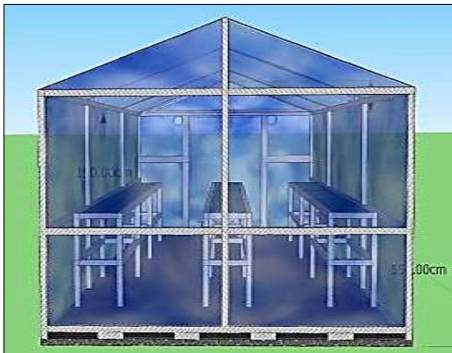
Gambar 9. Rancangan 3D rumah pengering biji kopi tipe (ERK) dari arah belakang.
