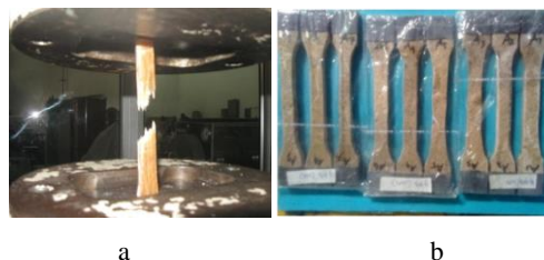
Gambar 1. (a) Spesimen uji tarik komposit buah lontar polyester standar ASTM D638 (b) Proses pengujian tarik.
