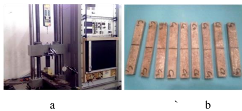
Gambar 2. (a) Spesimen uji bending komposit serat buah lontar menggunakan standar uji ASTM D790, (b) Prosedur pengujian bending.
