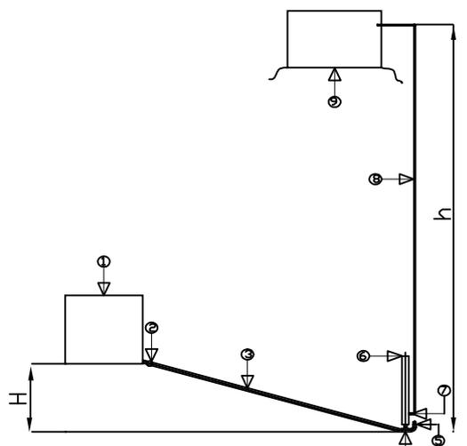
Gambar 4. instalasi pompa hidram untuk pengujian
