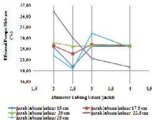
Gambar 5. Pengaruh Diameter Tabung Udara Terhadap Efisiensi Pompa Hidram
