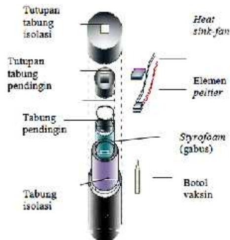
Gambar 3. Model Tabung Vaksin Dengan Menggunakan Elemen Peltier
