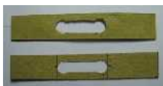
Gambar 4. Karton untuk pengujian serat tunggal menurut ASTM D3379
