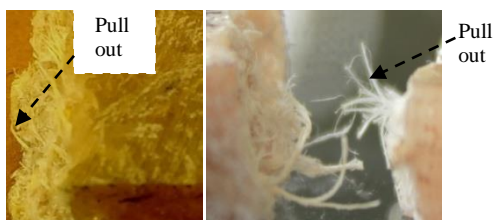
Gambar 11. Foto Patahan Spesimen Uji Tarik
