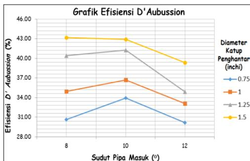
Gambar 6. Grafik hubungan Sudut Pipa masuk dan Diameter Katup penghantar terhadap Efisiensi D'Aubussion (%) Pompa Hidram 2 Inchi.
