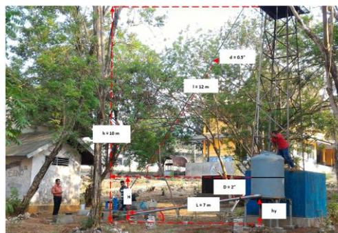
Gambar 5. Instalasi pengujian pompa
