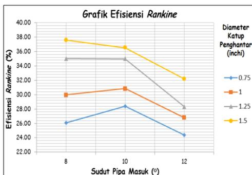
Gambar 7. Grafik Pengaruh Variasi Sudut pipa masuk dan Diameter Katup Penghantar terhadap Efisiensi Rankine (%) Pompa Hidram 2 Inchi.
