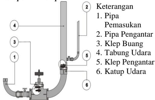
Gambar 2. Bagian Utama Pompa Hidram
