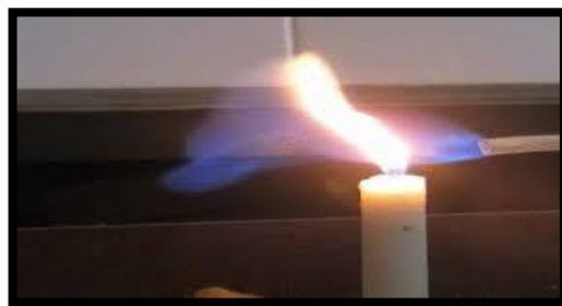
Gambar 1. Nyala api biogas
