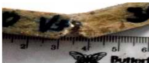
Gambar 16 Foto makro spesimen dengan fraksi volume 30%
